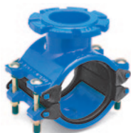
Serie 257 Universal-Schelle mit Flanschanschluss DN 100-300 Gas: PN 7 Wasser: PN 16 GJS
