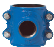
Serie 10 Anbohrschelle für PVC- und PE- Druckrohre DN 40-300 GJS Unterteil aus nichtrostendem Stahl ab DN 250
