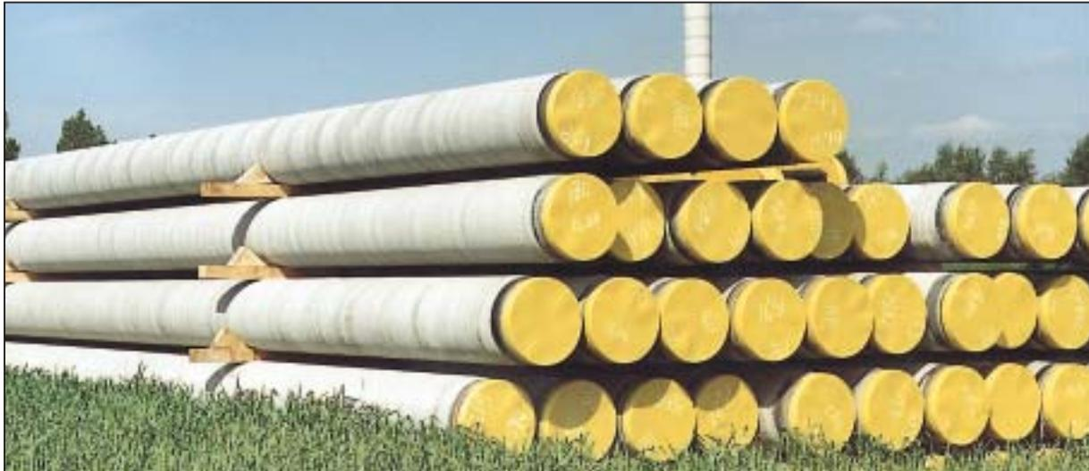
Nach W 346 soll die maximale Stapelhöhe für Rohre mit ZM-Auskleidung im Normalfall die Werte der Tabelle 8.1 nicht überschreiten.
