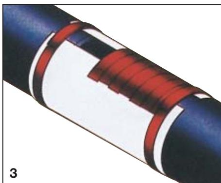
3. In Gefällestrecken muß der Einfüllspalt soweit abgeklebt werden, daß ein Herauslaufen des Gießmörtels aus der Verschalung verhindert wird.
