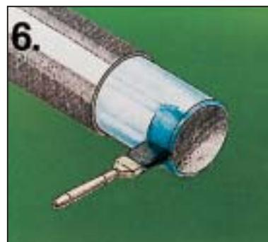
6. Aufbringen eines für Trinkwasser zugelassenen Beschichtungstoffes auf das Spitzende.
