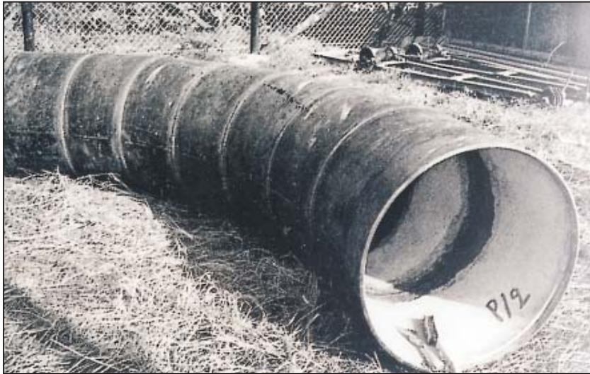
Die Nachauskleidung von Stumpfschweißverbindungen bei nicht befahrbaren Stahlleitungsrohren für Trinkwasser ist in der Regel nicht erforderlich („Selbstheilungseffekt“). Analoges trifft für Einsteckschweißmuffen- und Überschiebschweißmuffen-Verbindungen zu (Anwendung für Trinkwasser).
